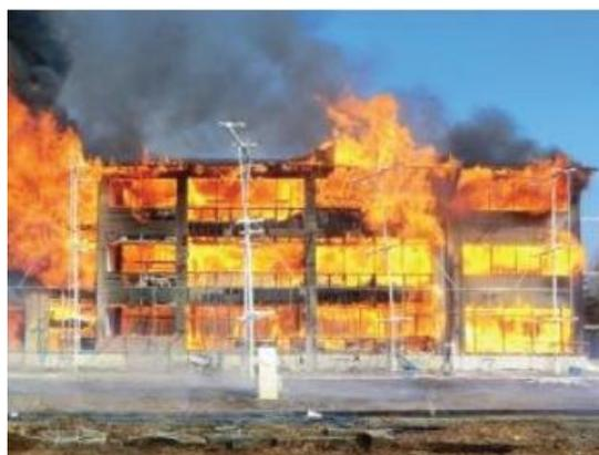
木造3階建て学校の実大規模の火災実験
