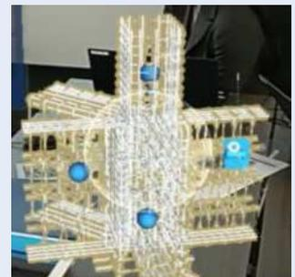
Microsoft HoloLensに投影した鉄筋モデル
